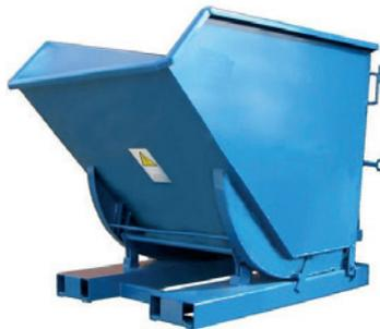
Estos contenedores suelen tener el sistema de volteo integrado. La cuba suele tener forma de triángulo, con el peso en la punta para que cuando se libere el mecanismo, y con un poco de inclinación de la carretilla elevadora, bascule.
